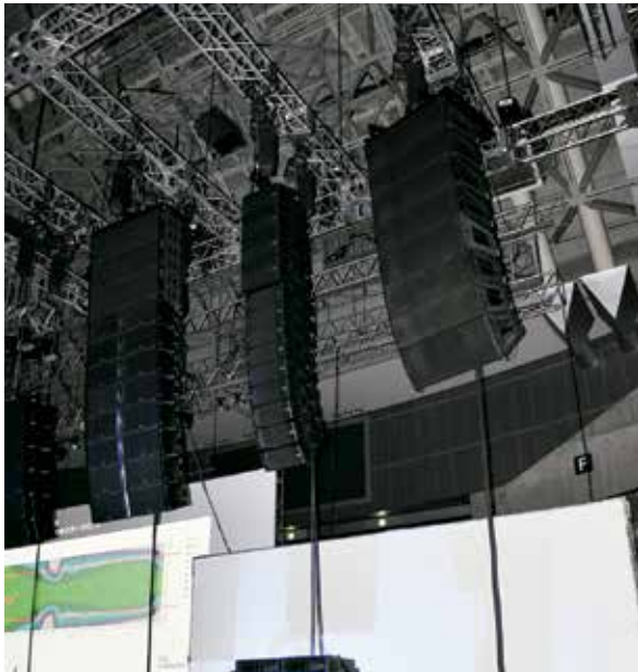
↑トラス構造の骨組みに各社のラインアレイPAスピーカーを吊り下げて設置し、順番に鳴らしながら試聴会が行なわれた
